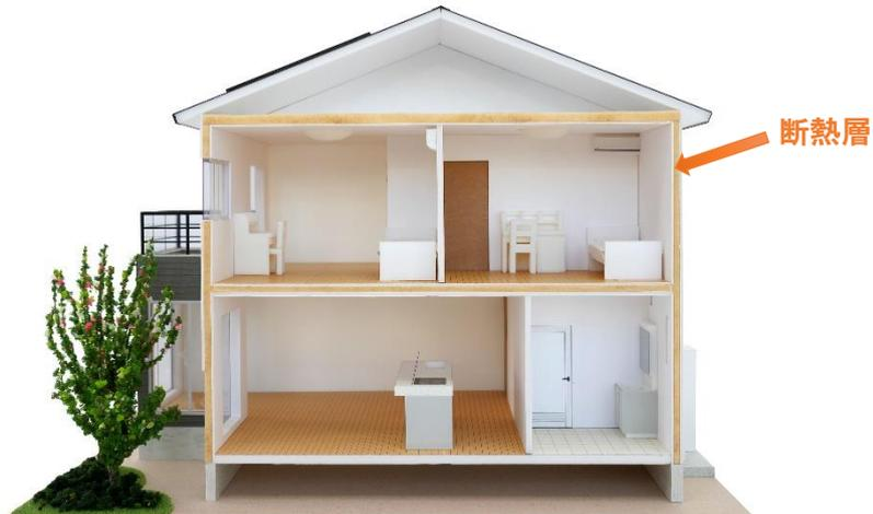
参考までに、ロックウールなどの繊維系断熱材を柱間に充てんする「木造軸組の壁構成」を例示します。
